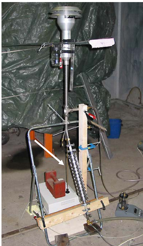
Figur 6 En 12-steps kaskadimpaktor (vid pilen) kopplad till APS-instrumentets PM_{10} -intag.
